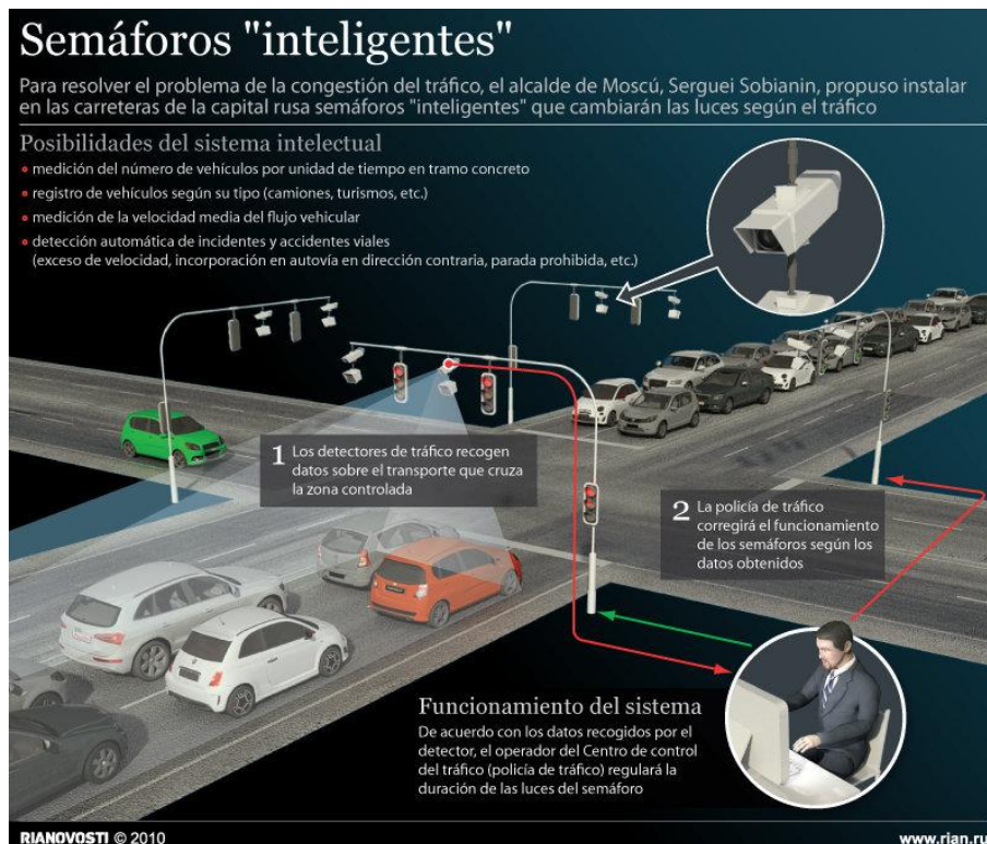
Figura 33 Esquema de funcionamento de semáforo inteligente (Fonte: http://www.marcoareliodeca.com.br/2012/11/11/semaforos-inteligentes/ )
