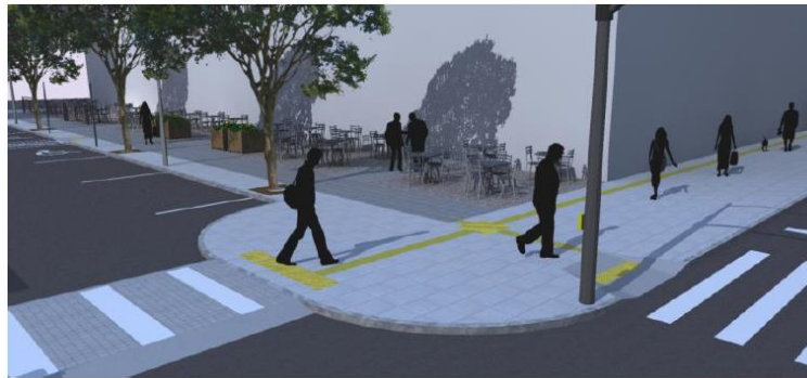
Figura 56: Rampa de Acesso Para Faixa de Pedestres e Lombofaixa (Fonte: Guia Prático Para a Construção de Calçadas)
