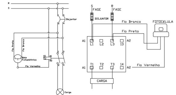
DETALHAMENTO QUADRO DE COMANDO DE ACIONAMENTO SEM ESCALA
